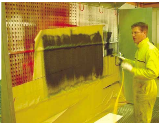
Spritzversuch: Kolbenpumpe für Bitumendickbeschichtung mit Pulverkomponente für hohen Betriebsdruck
