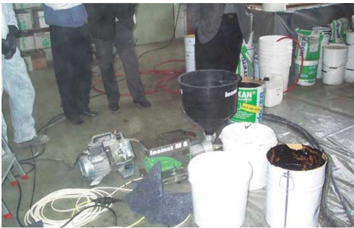
Abb. 3: Für geringeren Betriebsdruck: Peristaltikpumpe
