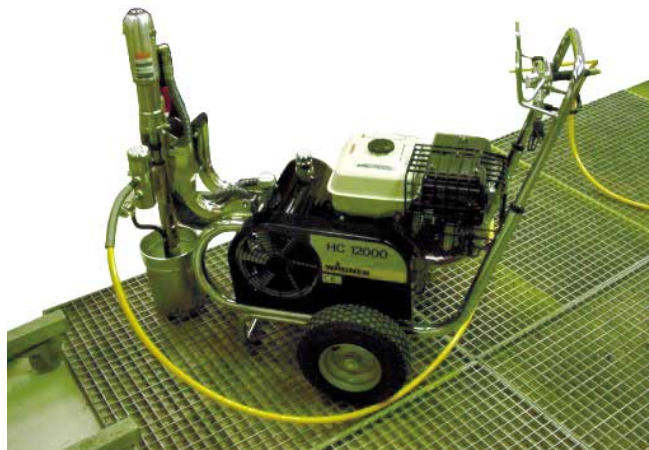
Spritzversuch: Kolbenpumpe für Bitumendickbeschichtung mit Pulverkomponente für hohen Betriebsdruck
